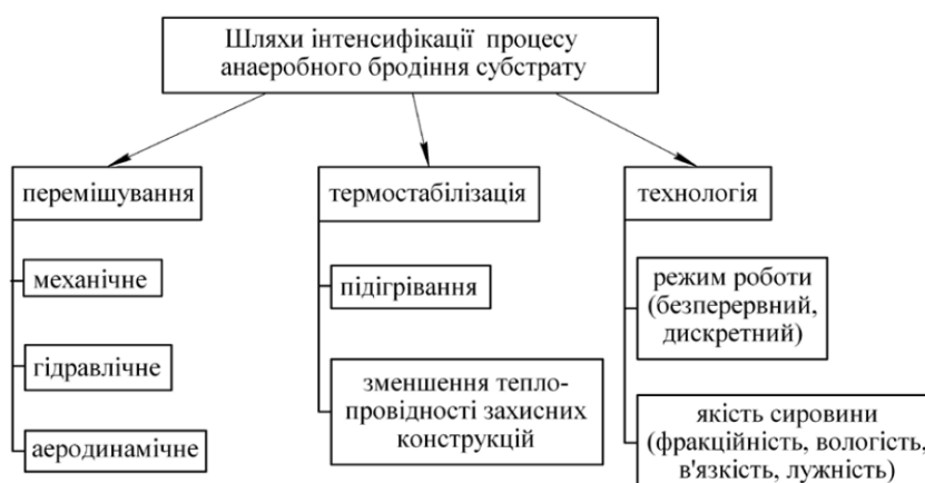
Рис.1. Структурна схема шляхів інтенсифікації процесу анаеробного бродіння субстрату в біореакторах
