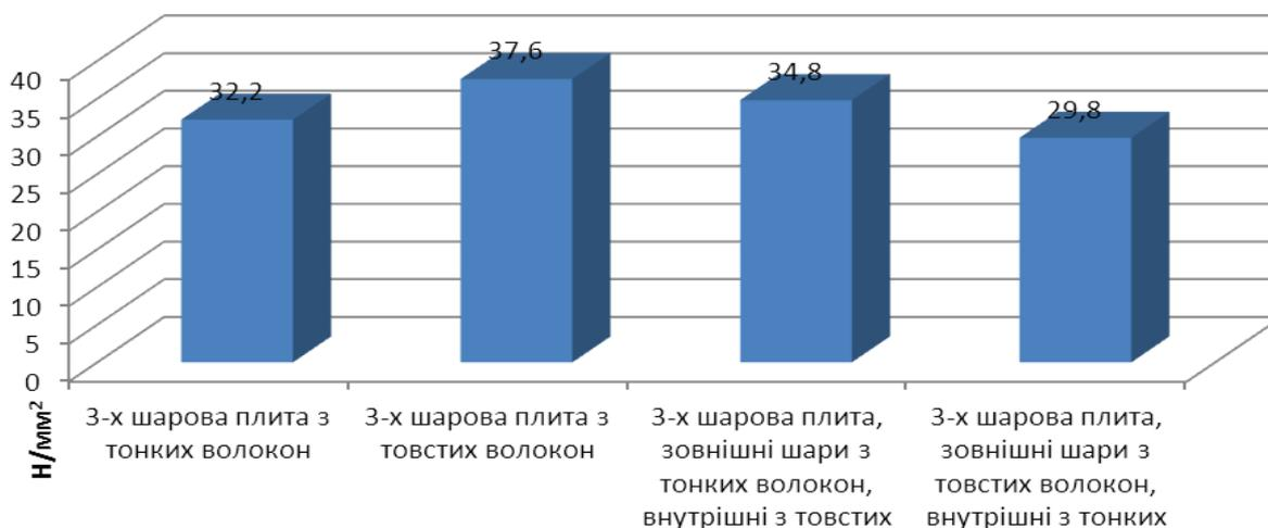
**Рис. 5. Середні значення межі міцності під час згинання різних типів тришарової плити на фенолформальдегідному в'язучому**
