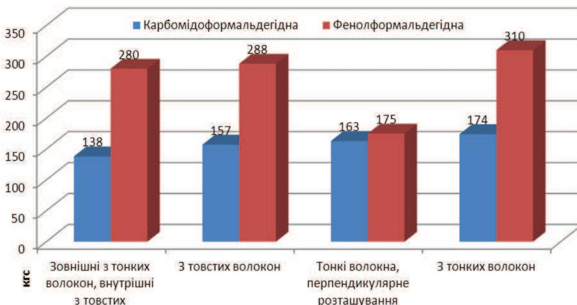
Рис. 2. Середні значення межі міцності під час згинання різних типів плит на карбомідоформальдегідному та фенолформальдегідному в'язучому
