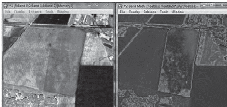
Рис. 4. Приклад виділення області з найбільшою біомасою рослин на прикладі індексу NDVI (праворуч) та космічного зображення з ШСЗ Rapid Eye (ліворуч) [12]
